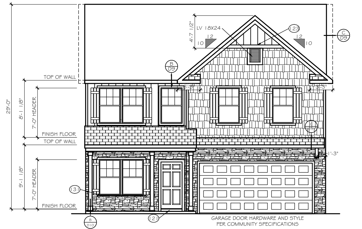
FRONT ELEVATION SCALE: 1/8" = 1'-0"
